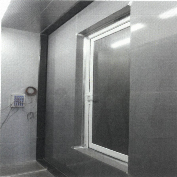
<사진 1> 열관류율 향온측 시험체 모습
